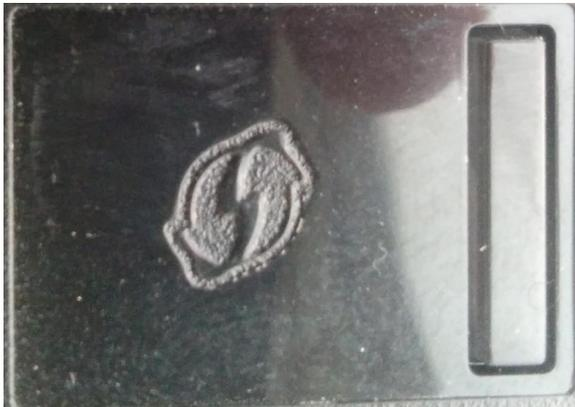
En la parte superior del equipo hay localizado un botón cuya función es encender y apagar los interfaces wifi.
