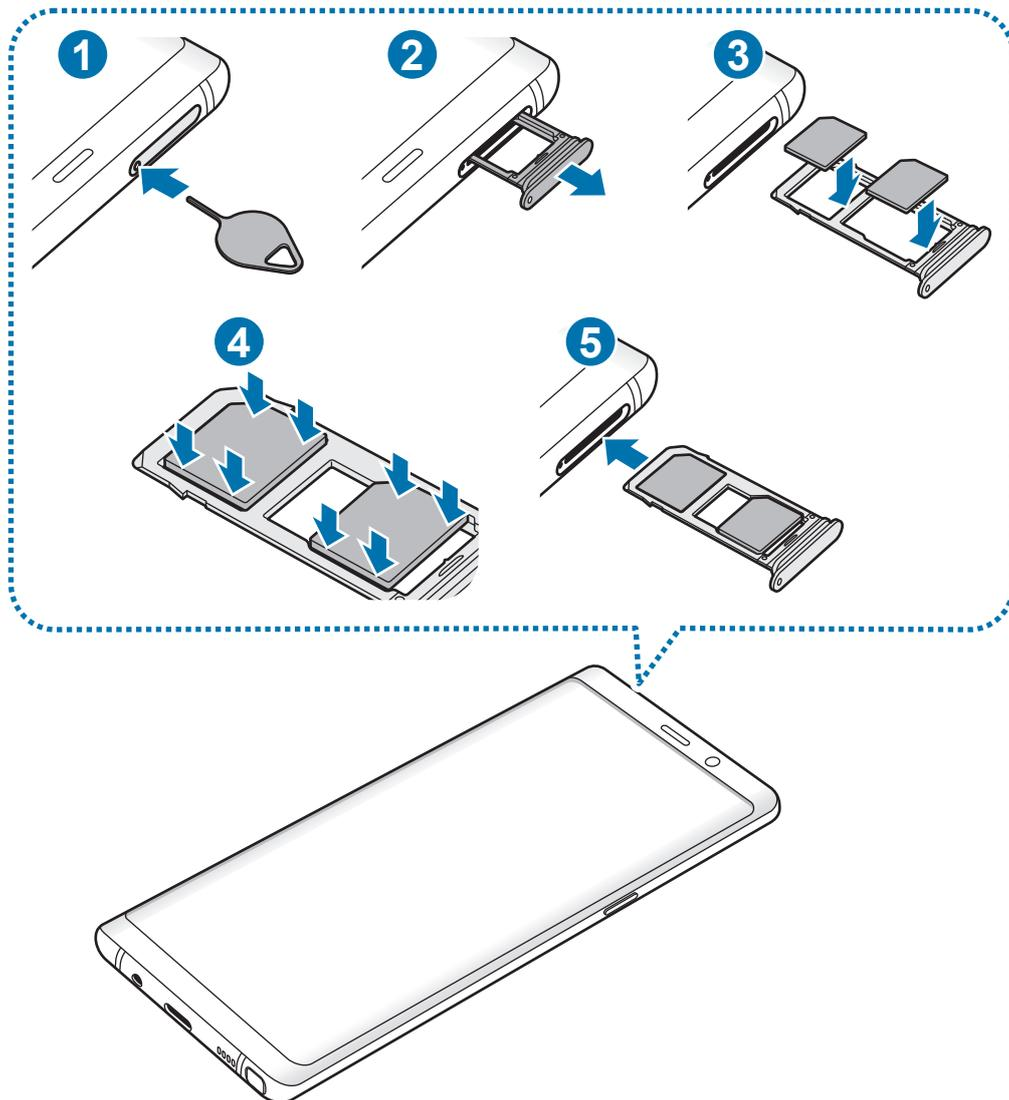
1 Para extraer la bandeja de la tarjeta SIM, inserte la anilla de extracción en el orificio de la bandeja.
